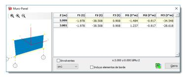
Si el campo Muro está definido, ECO muestra una ventana con el equilibrio de todos los paneles que forman el muro, en ejes de estructura si el campo Panel principal no está definido.
