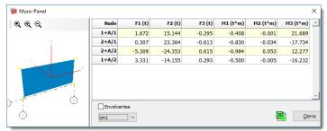
Si se hace clic con el botón derecho, teniendo la techa shift oprimida, ECO despliega una ventana que muestra el equilibrio del panel seleccionado, en ejes locales, si no se tiene el campo Muro definido.
