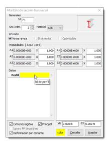
Al hacer clic en el campo Perfil, ECO despliega una ventana similar a la mostrada, donde se agregan perfiles al catálogo particular del edificio.
