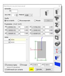
Después de capturar la 1d que tendrá en el catálogo de secciones transversales del edificio, se selecciona Perfil metálico dando clic en el botón Tipo. Al seleccionarlo, en la zona de datos aparece el campo Perfil.
