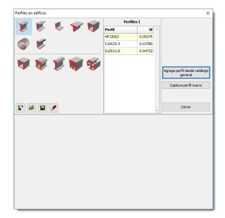
También se puede agregar un perfil al hacer clic sobre el botón Captura perfil nuevo. ECO despliega las dimensiones por omisión del tipo de perfil vigente y permite su edición.
