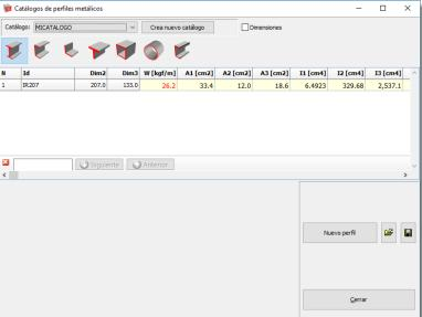
Los botones se emplean para grabar y leer un archivo ASCII de texto, con TABS como separadores, con la información de los perfiles. Esto permite trasladar perfiles entre catálogos o hacer la edición usando alguna hoja electrónica.
